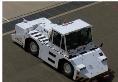
空港で働く電源トラクター
